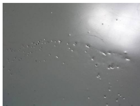
Figuur 5-1 Voorbeeld pinholes.
